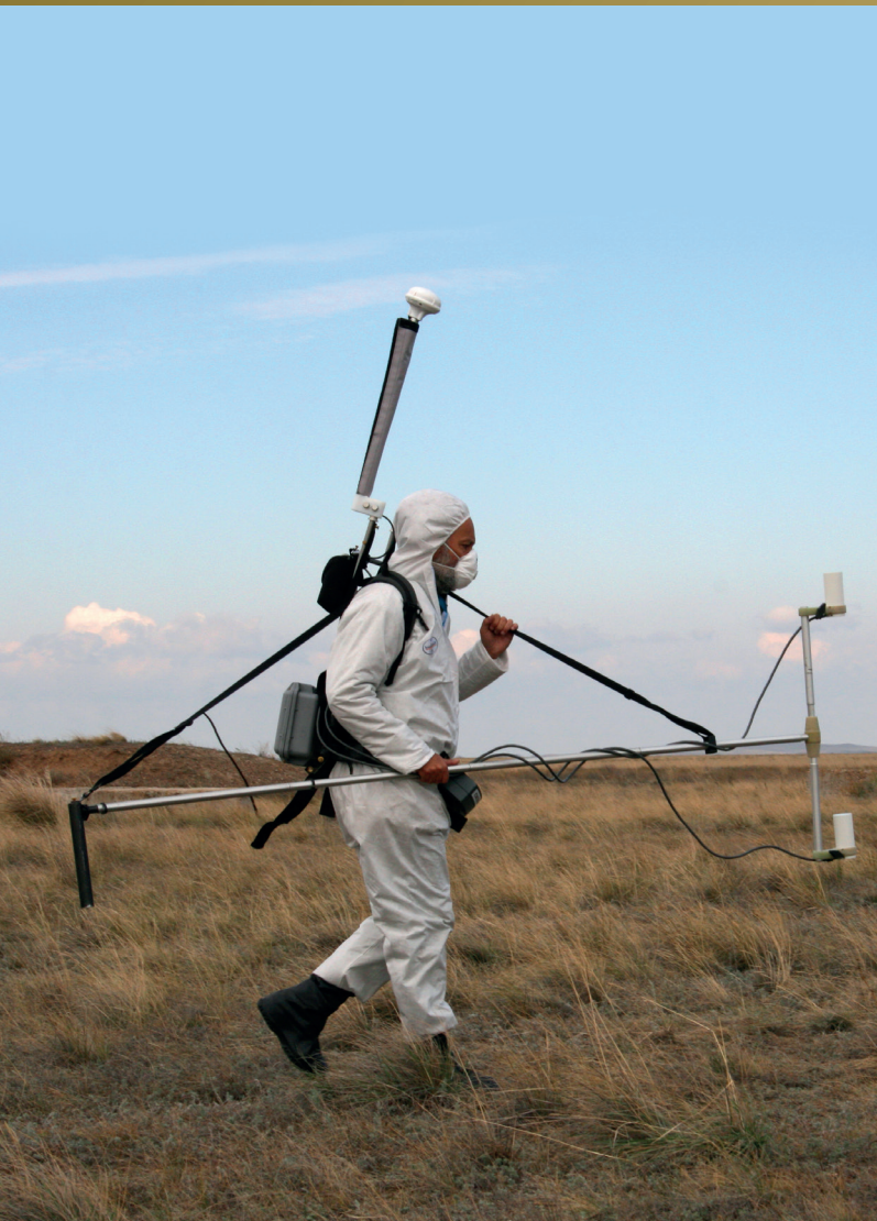
一名现场视察专家携带着磁强计，这是一种测量地球磁场偏差的仪器，有助于识别可能由地下核爆炸造成的空穴
